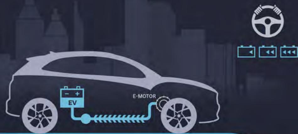
Regeneratives Bremsen durchgeführt durch das Fahrzeug
